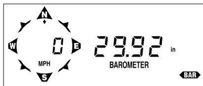
*STEADY BAROMETRIC PRESSURE INDICATOR*
